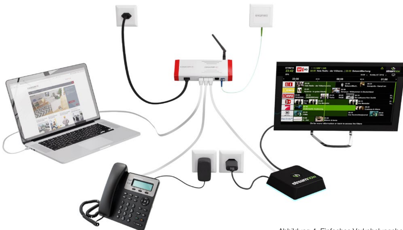
Abbildung 4: Einfaches Verkabelungsbeispiel
