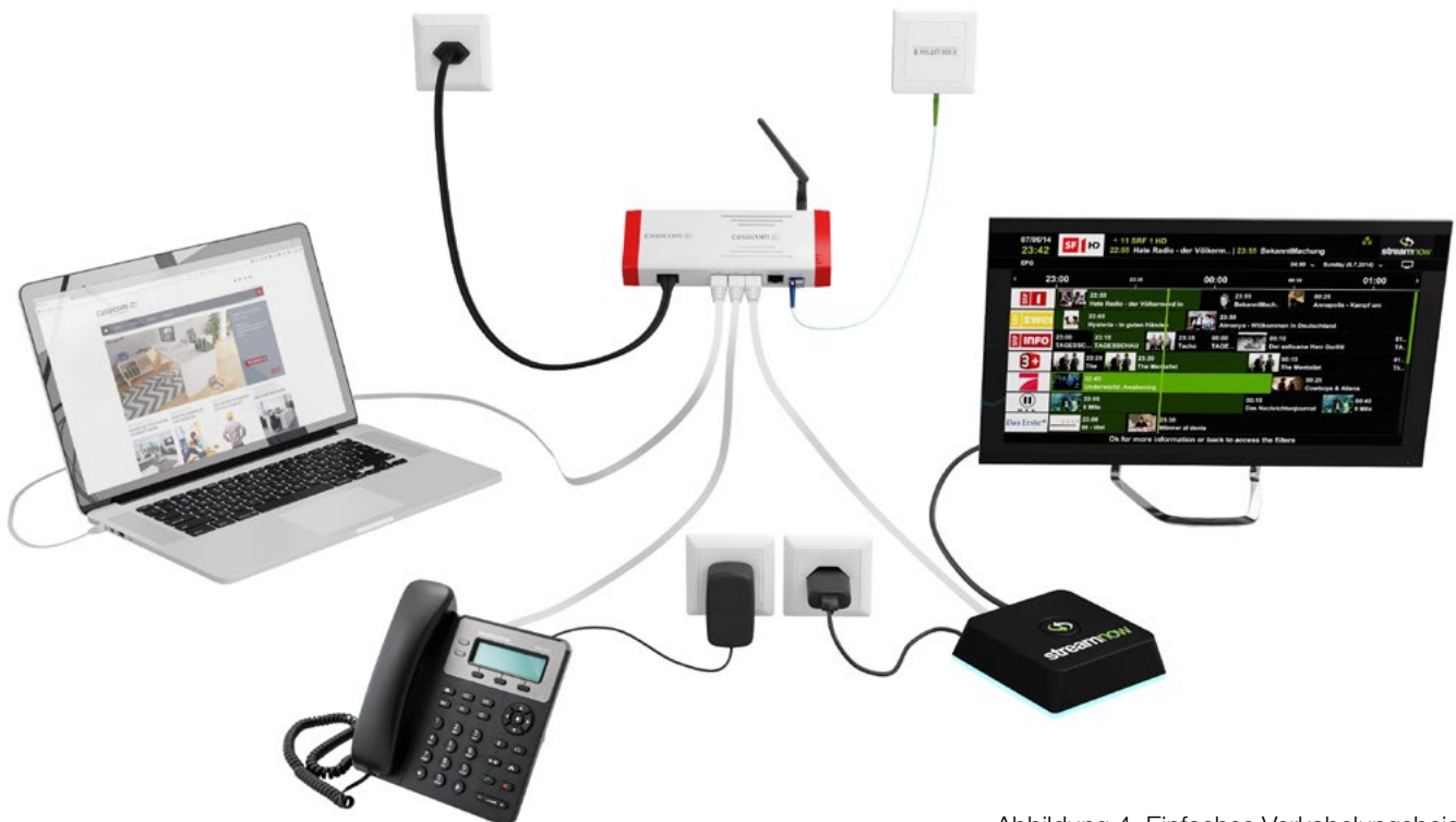
Abbildung 4: Einfaches Verkabelungsbeispiel
