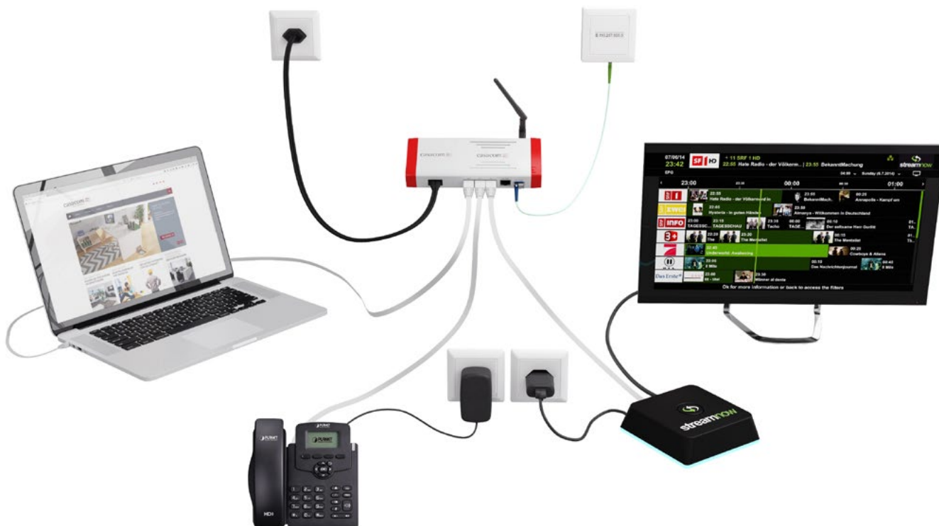
Abbildung 4: Einfaches Verkabelungsbeispiel
